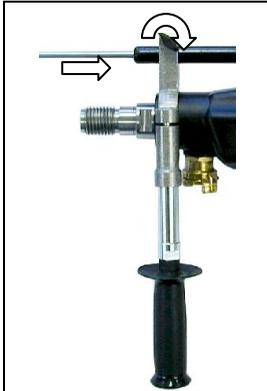
Setzen Sie die Gasdruckfeder mit dem Wassersammelring und dem zum Bohrkronendurchmesser passenden Führungsring in die Spannschelle ein. Verschieben Sie die Gasdruckfeder so weit, bis die Segmente der Krone vom Wassersammelring verdeckt sind. Ziehen Sie die Flügelschraube fest.
