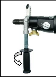
Im Handbetrieb darf die **ETN 130/3 P** nur in Verbindung mit dem beiliegenden Zusatzhandgriff betrieben werden. Dieser wird von vorn auf den Getriebehals aufgesteckt und durch Drehen des Handgriffes in Pfeilrichtung fest angezogen.
