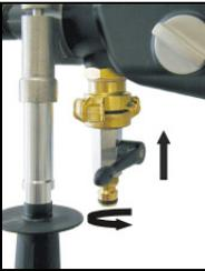
Setzen Sie den Adapter mit dem Kugelhahn auf den Anschluss der Maschine auf und drehen Sie ihn in Pfeilrichtung gegen den Anschlag. Schließen Sie die Maschine über das Stecknippel an die Wasserversorgung oder ein Wasserdruckgefäß an. **Achtung! Der maximale Wasserdruck sollte 6 bar nicht überschreiten. Bei höherem Wasserdruck ist ein Druckminderer bauseits zu verwenden.**
