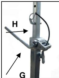
Positionieren Sie den Bohrständer. Setzen Sie die Schnellspannsäule so dicht wie möglich hinter der Säule auf dem Ständerfuß auf. Fixieren Sie den Bohrständer durch Drehen der Kurbel (G) im Uhrzeigersinn. Sichern Sie die Einstellung mit dem dazugehörigen Bolzen (H).
