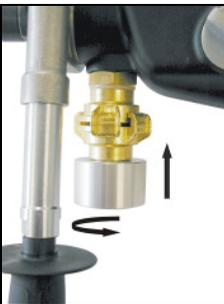
Beim Arbeiten entstehender Staub ist gesundheitsschädlich. Bei Trockenbohrungen ist deshalb ein Staubsauger zu verwenden und eine Staubschutzmaske zu tragen. Setzen Sie den Adapter für die Staubabsaugung auf den Anschluss der Maschine und drehen Sie ihn in Pfeilrichtung gegen den Anschlag. Der passende Nass-Trocken-Sauger DSS 25 A ist als Zubehör erhältlich. Die Verwendung einer Absaugung ist ebenfalls Voraussetzung für eine optimale Schnittleistung der Bohrkronen (Luftkühlung).
